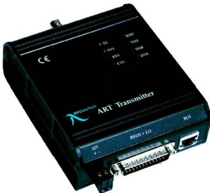
**L'émetteur** permet en étant raccordé à une unité centrale par une liaison RS232 ou RS422 (avec l'utilisation de convertisseur : CONV 232/422) de gérer les appels d'un recherche de personnes et 2 contacts d'alarmes.
