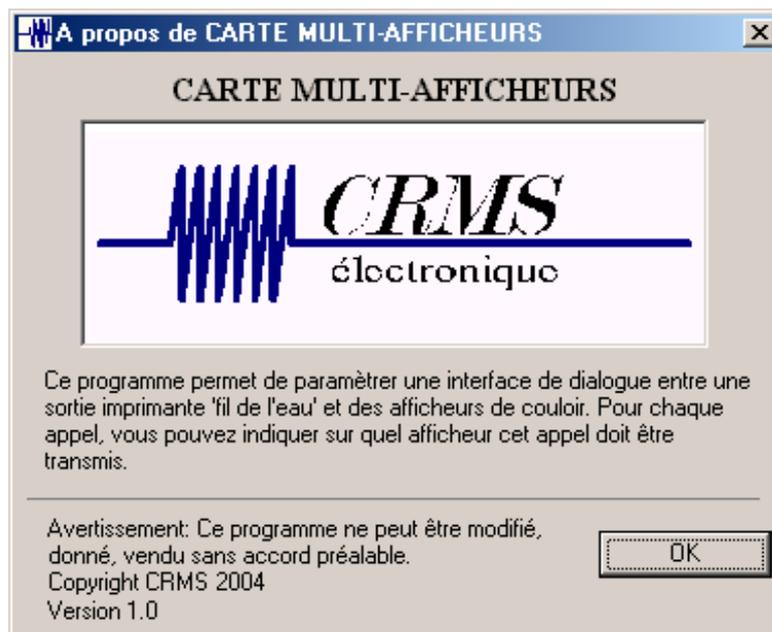
L'interface MULTIAFFICHEUR permet de transmettre des messages textes vers des afficheurs géants d'une ligne de texte en mode déroulant ou vers des mini afficheurs de deux lignes.
