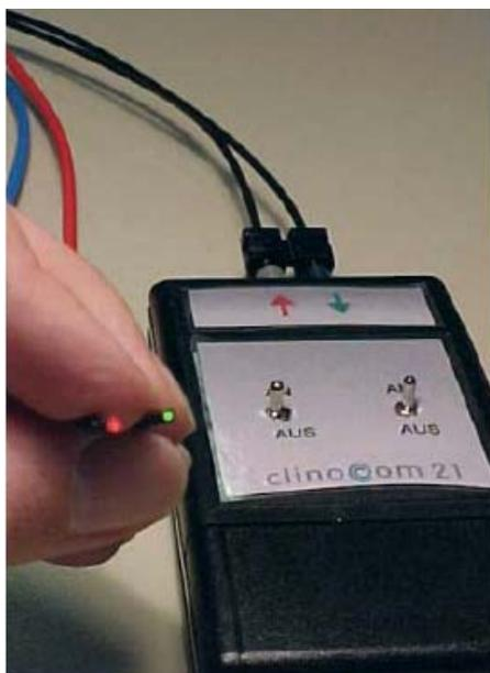
On peut identifier le sens d'une fibre (direction du signal) avec une lampe de poche ou un appareil spécial.
