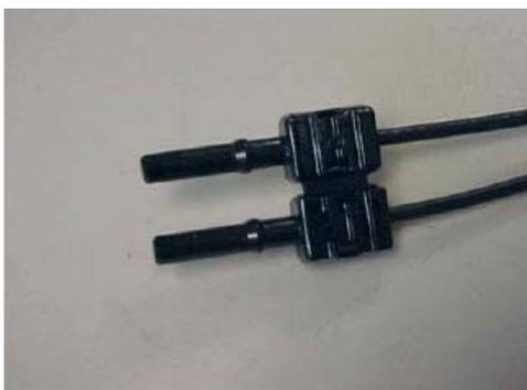
2 connecteurs similaires (crimpless) peuvent être transformés en un connecteur duplex. Le connecteur Duplex n'est pas détrompé!
