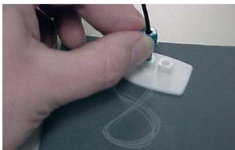
Polire la fibre avec un set de polissage :
