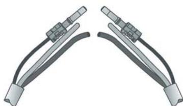
Câble système 4 fils sans halogène pour l'alimentation 24 V CC (2 x fil torsadé cuivre) et la transmission des données et de la voix (2 x fibre optique plastique). La longueur maximale entre les différents composants (modules) du bus de chambre est de 20 m. Au-delà, il convient d'utiliser un module amplificateur.
