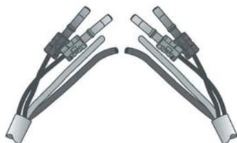
Câble système 4 fils sans halogène pour l'alimentation 24 V CC (2 x fil souple cuivre) et la transmission des données et de la voix (2 x fibre optique plastique). La longueur maximale entre les différents composants (modules) du bus de couloir est de 50 m. Au-delà, il convient d'utiliser un module amplificateur.
