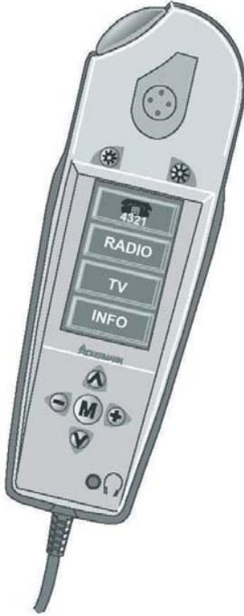
Le terminal patient permet, entre autres, au patient de déclencher des appels, de commander sa radio et sa télévision, de commander l'éclairage, et, en option, de téléphoner. En plus des touches destinées à l'appel, à la commande de l'éclairage et à la navigation à travers les menus, le terminal dispose d'un afficheur à cristaux liquides rétro-éclairé à surface tactile.
