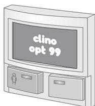
Ce module de porte avec afficheur doit être monté sur un module électronique avec bus-lit comme le hublot d'office. Ce module permet la visualisation des appels du service sur un afficheur 2x8 caractères lorsque la présence est activée. Un bouton vert sert au marquage de la présence 1 (vert) et le bouton rouge à la génération d'un appel. Un buzzer est intégré pour le report d'appel sonore.
