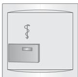
Le bloc d'appel comprend un bouton rouge rétro-éclairé avec voyant de tranquillisation à LED rouge et contact à ouverture auto-surveillé ou fermeture.
