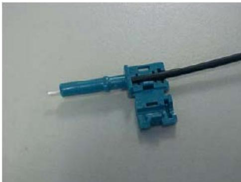
Enfichez la fibre à fond dans le connecteur, de manière à ce que la fibre dépasse du bout du connecteur
