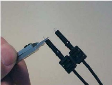
Ou encore coupez la fibre avec une pince coupante. La coupe de la pince doit être une coupe à ras (coupe droite) La pince coupante ne doit être utilisée que pour le cœur d'une fibre optique!
